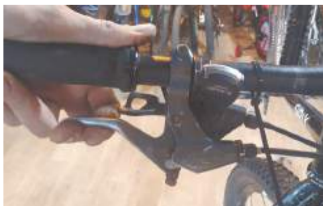
Ручка тормозов доходит до упора и возвращается обратно
